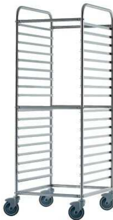
● 937000 CARRELLO PORTATEGLIE 18 GN 2/1 O 36 GN 1/1 H 6,5 cm 62x74 H 164 DISTANZA FRA PIANI cm 6,9 PORTATA MASSIMA KG 300 Ø RUOTE cm 12,5
