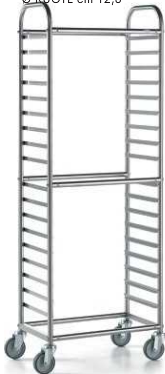
● 13216 CARRELLO PORTATEGLIE 18 GN 1/1 H 6,5 cm 62x38,5 H 161 DISTANZA FRA PIANI cm 6,9 PORTATA MASSIMA KG 150 Ø RUOTE cm 10
